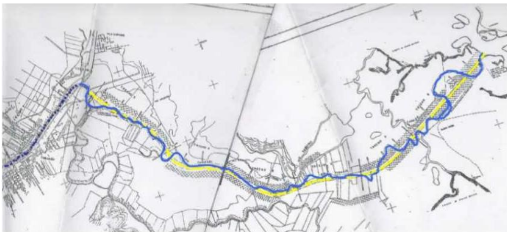
Figura 50: Obra de retificação do Rio Tubarão, em azul o curso do Rio antes da obra, em amarelo após. Fonte: Corpo de Bombeiros de Santa Catarina, 2011 (extraído de Nunes Jr., 2016).
